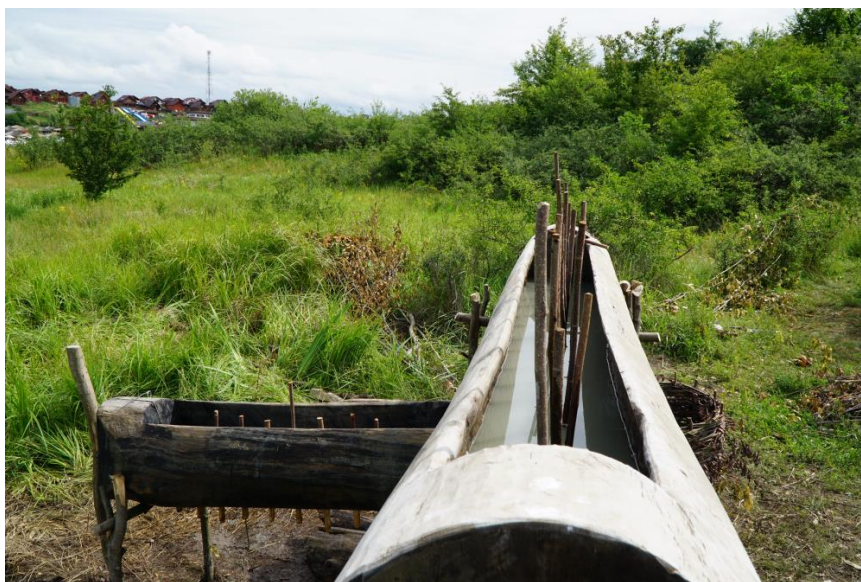
Situl Băile Figa, jud. Bistrița-Năsăud. Slatină cu nămol (tulbure) lăsată la decantare în Troaca mare
