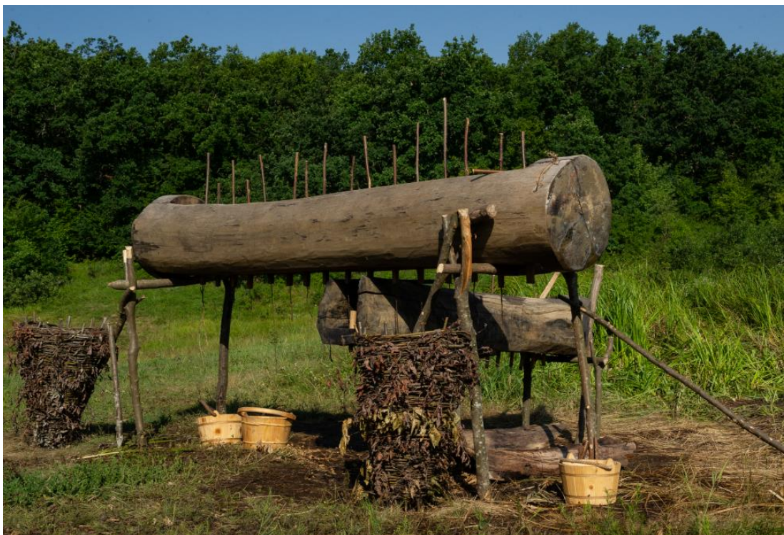
Situl Băile Figa, jud. Bistrița-Năsăud. Activitatea de filtrare a slatinei cu ajutorul trocilor de lemn după ce nămolul
