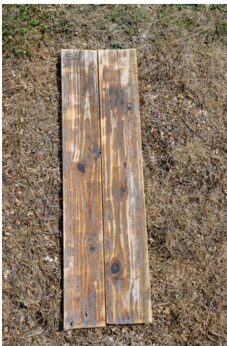
Situl Băile Figa, jud. Bistrița-Năsăud. Obținerea sării cristalizate din slatină prin stropirea scândurilor și expunerea lor la soare
