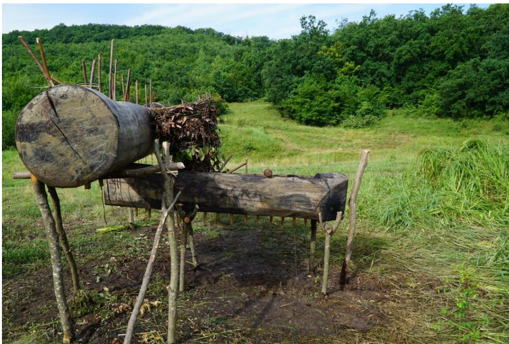
Situl Băile Figa, jud. Bistrița-Năsăud. Instalații (troaci, cepuri, ace, sfori, picioare, coșuri) de spălarea nămolului sărat cu apă dulce
